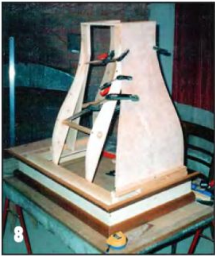
Тщательно шлифуем поверхности и кромки фанерных стенок, после чего покрываем их грунтом.
