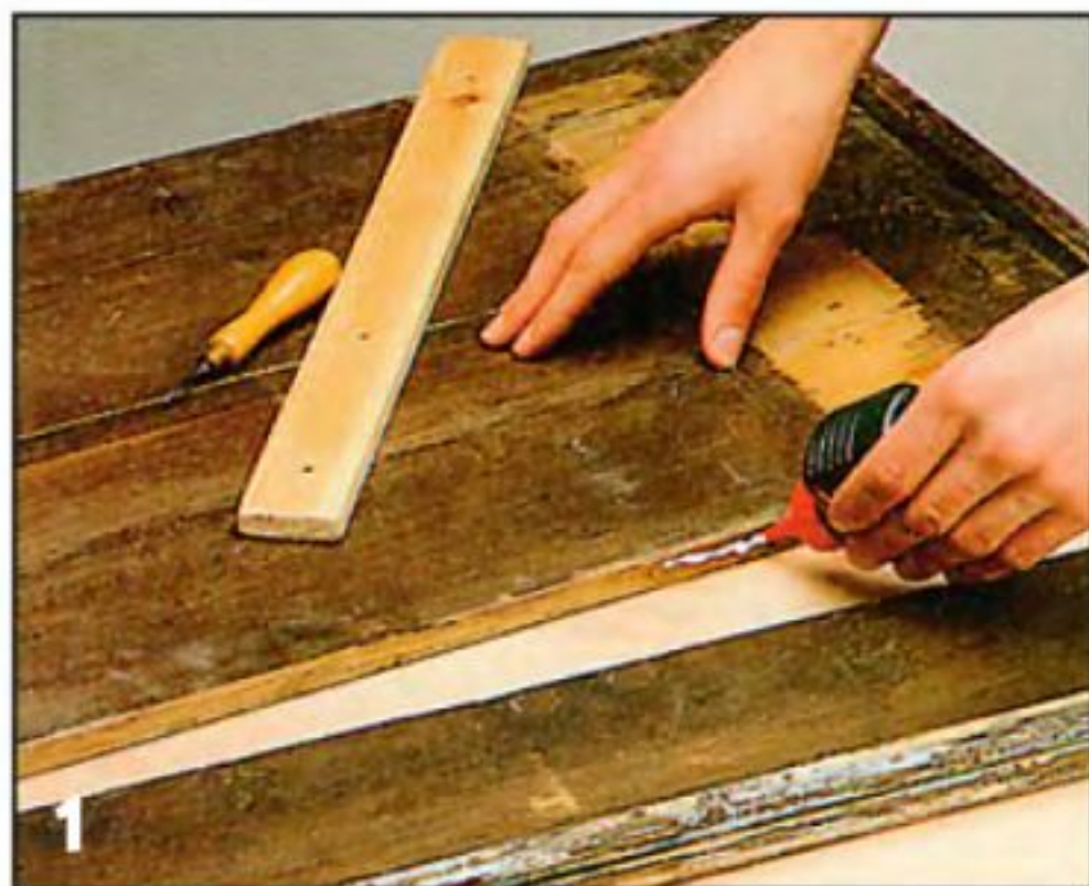
1 На продольные кромки обработанных досок крышки наносят клей и соединяют доски друг с другом.
