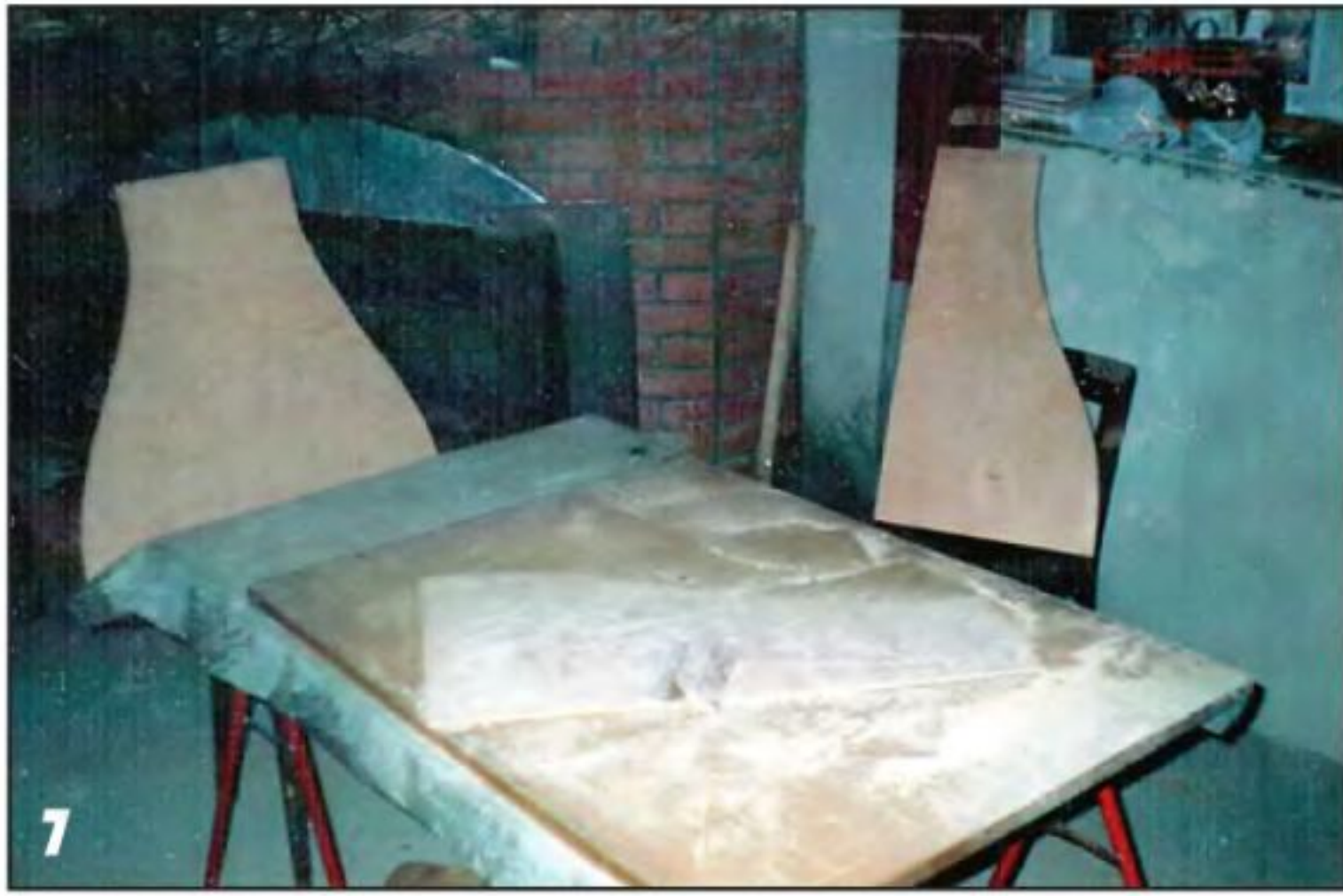
Тщательно шлифуем поверхности и кромки фанерных стенок, после чего покрываем их грунтом.
