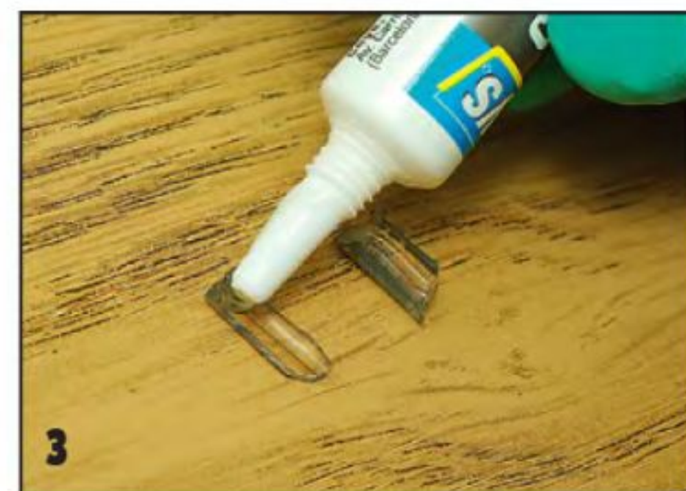
Обезжирив поверхности деталей (осколков) ацетоном, наносим капельку клея на одну из склеиваемых поверхностей. Работы с ацетоном следует проводить в хорошо проветриваемом помещении или в респираторе с защитой от органических паров.
