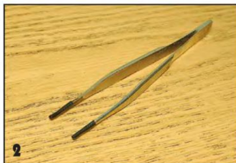
Для склеивания осколков пригодится пинцет. Только его надо немного доработать — надеть на кончики отрезки изоляции электропровода (кембрики), ведь клей обладает адгезией не только к стеклу, но и к металлу тоже. А кембрики защитят пинцет от «несанкционированного» приклеивания к осколкам газели.
