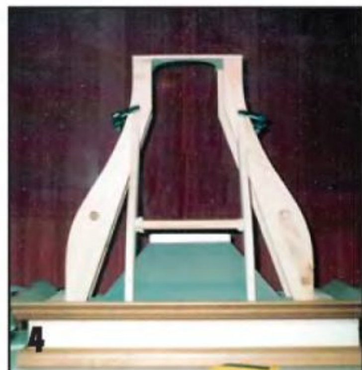
Собираем задуманный деревянный каркас, который позволит потом придать элегантную форму этой вытяжке.
