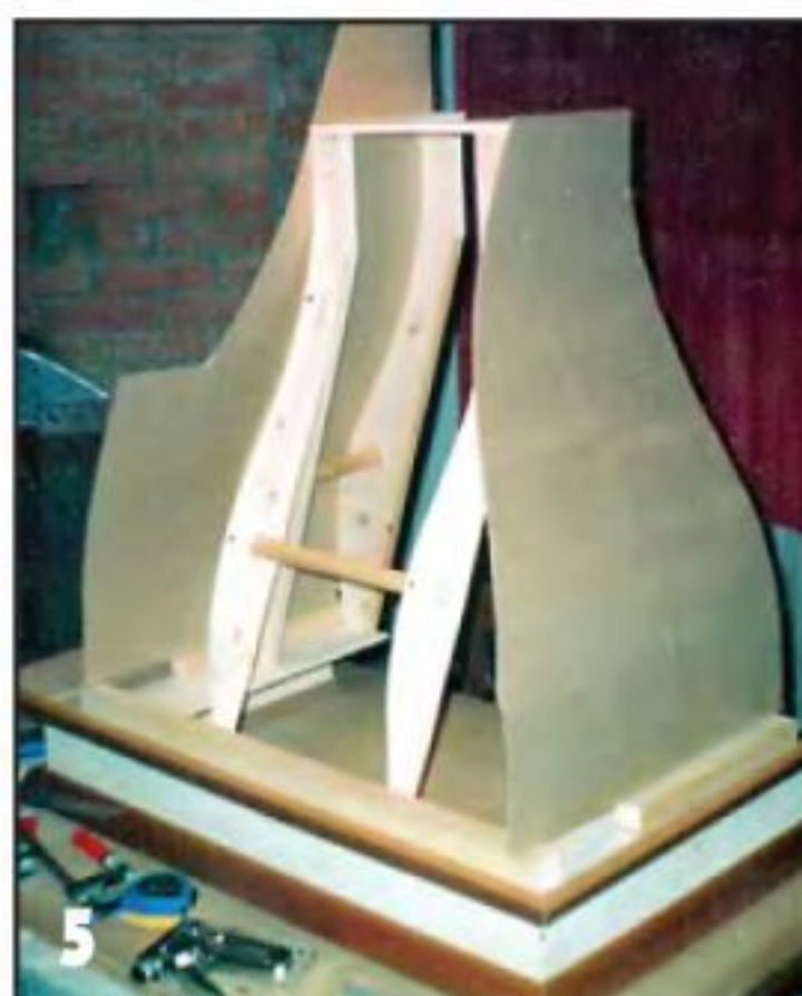
Из тонкого картона вырезаем шаблоны стенок вытяжки.
