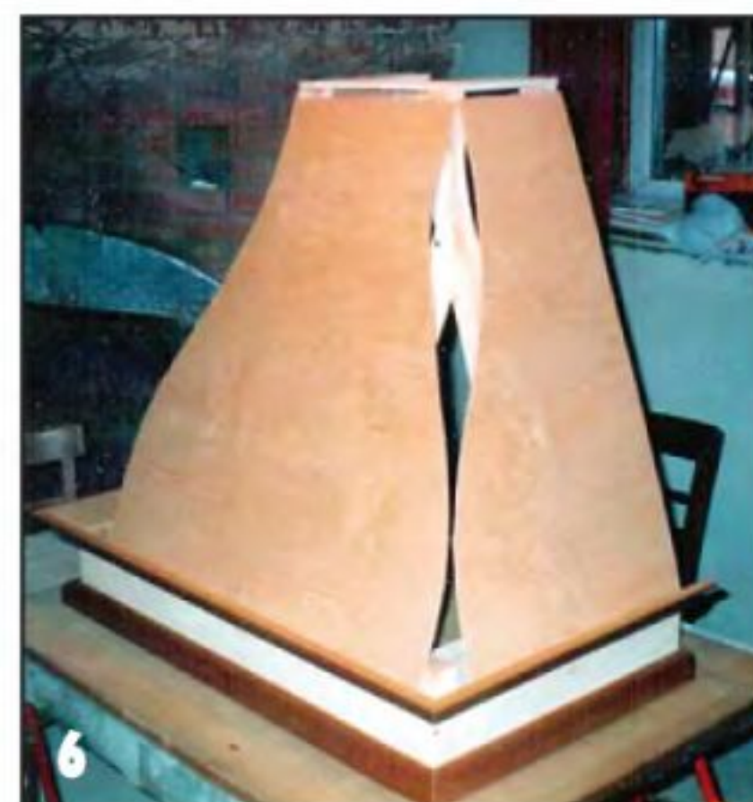
По этим шаблонам из тонкой гибкой фанеры выкраиваем сами стенки.
