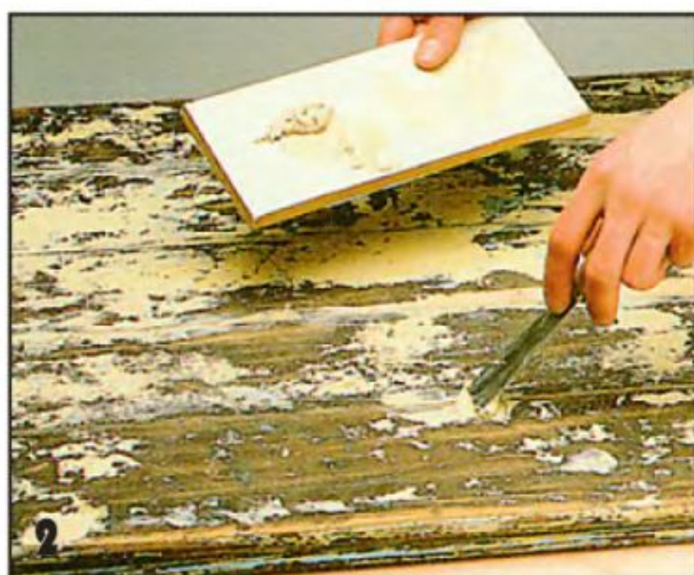
2 Все повреждённые места шпатлюют древесной замазкой.
